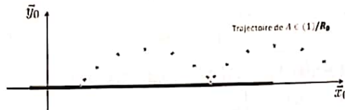
Trajectoire du point A appartenant à la roue (1) par rapport au repère lié au sol (0)
